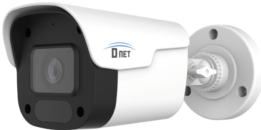
A câmera Bullet DN-IPC - B2EF2825 oferece imagens de alta qualidade com resolução de 2MP com sensor CMOS de varredura progressiva de 1/3". Com suporte a compressão H.264/H.265/-JPEG/AVI/MJPEG, iluminação mínima de 0,04 Lux e IR 25 metros, proporciona vigilância eficaz em todas as condições de iluminação. Possui suporte DWDR e uma carcaça de plástico resistente com classificação IP66, tornando-a adequada para uso externo. É uma solução completa para necessidades de vigilância exigentes.
